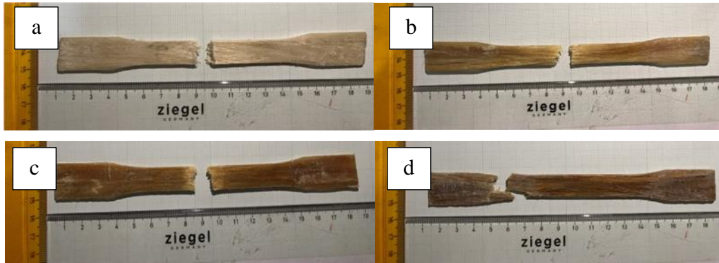
Gambar 9. Patahan Komposit Serat Daun Nanas: (a) TP, (b) 250W, (c) 440W, (d) 715W
