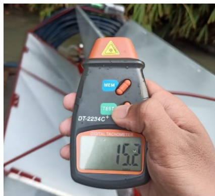
Gambar 4. Pengukuran Putaran Kincir
