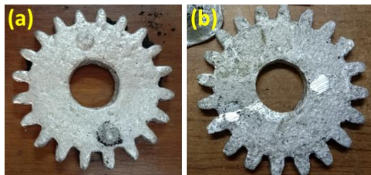
Gambar 7. Hasil pengecoran pasir sebelum proses finishing ; (a) Aluminium 1100, (b) Aluminium 6063
