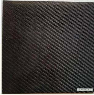
Gambar 3. CFRP yang digunakan sebagai sampel uji
