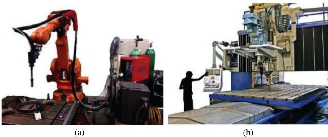
Gambar 1. Mesin yang digunakan pada WAAM; a. Robot 5 Aksis, b. Complex CNC Machine [12].
