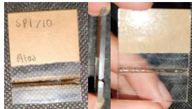
Gambar 8. Hasil pemotongan dengan media pelapis alas papan MDF hitam
