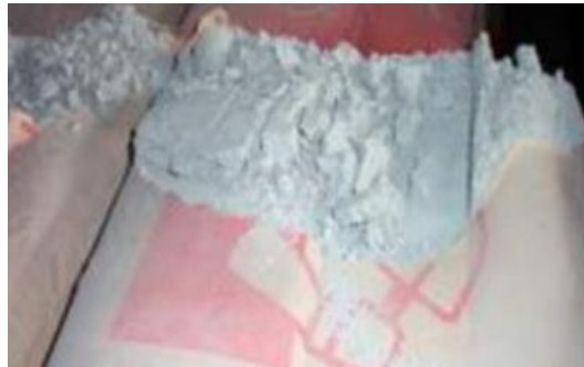
Gambar 5. Serbuk bahan baku semen hasil penghalusan menggunakan mesin roller milling .
